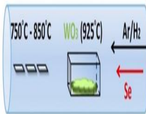
4 сурет – WS_2 және MoS_2 алу үшін газ фазасынан химиялық тұндыру CVD) әдісінің схемалық бейнесі [48]
